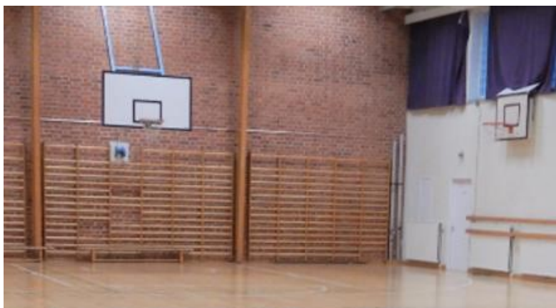
Kuva 4. Liikuntasali voi olla esimerkiksi sellainen tila, jossa mittaus metrin korkeudesta on mahdotonta ja ulkoilman lämpötilaolosuhteiden takia tulosten termisen paine-eron kompensointi tulee tarpeelliseksi.
