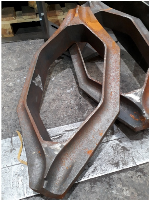
Kuva 4. Tyypillisiä soodakattilan sekundääri/tertiäriaukon valukappaleita
