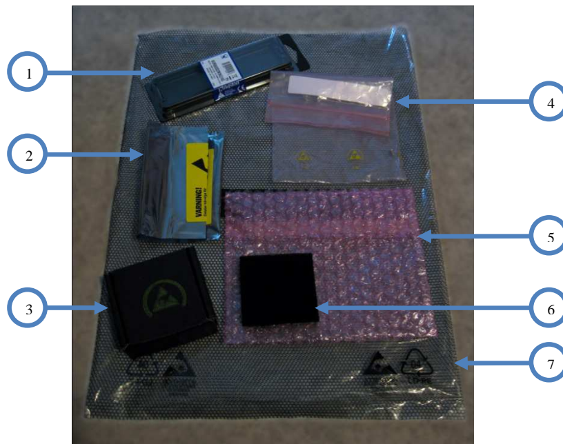
Kuva 6. Pakkaus- ja säilytysmateriaaleja. 1. Muistipiirin pakkausko-telo, 2. Metalloitu pussi, 3. Varauksia poistava pahvikotelo, 4. Heikosti varautuva pussi, 5. Heikosti varautuva kuplamuovipussi, 6. Varauksia poistava solumuovi, 7. Harvinaisempi ratkaisu varauksia poistavasta pussista (Katavisto, 2012).
