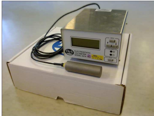
Kuva 9. Trek, elektrostaattinen jännitemittari. Mittarilla voidaan mitata mm. kehoon keräytyneitä varausjännitteitä. Kuvassa myös mittapäänä toimiva kävelyadapteri. (Katavisto, 2012).
