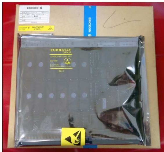
Kuva 12. Oikein pakattu piirikortti Parolan korjaamolla. Metalloitu pussi on suljettu tarralla ja ulkopakkauksessa on herkästä tuotteesta varoittava tarra. (Katavisto, 2012).
