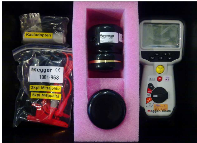
Kuva 8. Megger, eristysvastumittari resistanssimittauksiin. Kuvassa näkyy myös erilaisia mittauselektrodeja ja -johtoja. (Katavisto, 2012).
