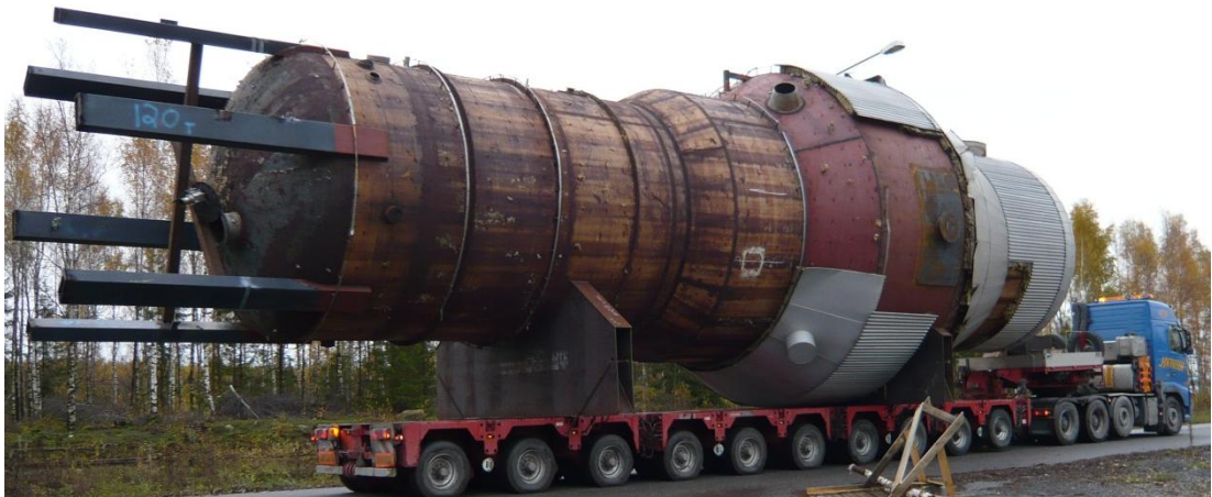
KUVIO 7. Haihdutinyksikkö kuljetustukineen Kaskisten sellutehtaalta.
