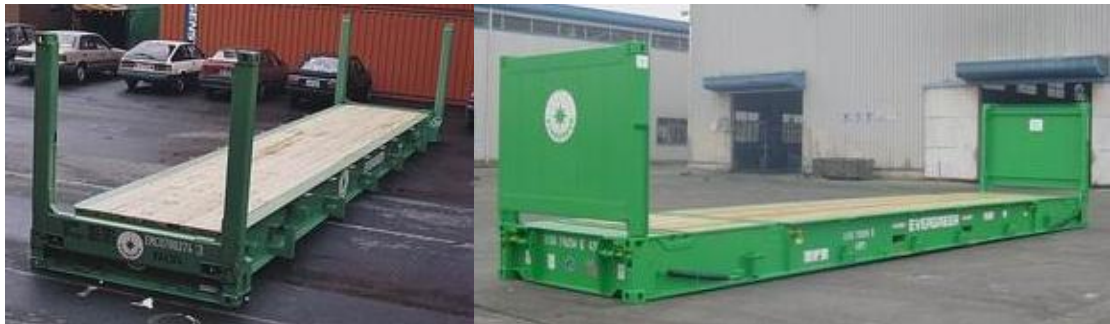
KUVIO 3. 40-jalkaiset Flat Rack – kontit 4 kulmatolpalla sekä taittuvilla päädyillä. (Evergreen-Marine.com 2012)
