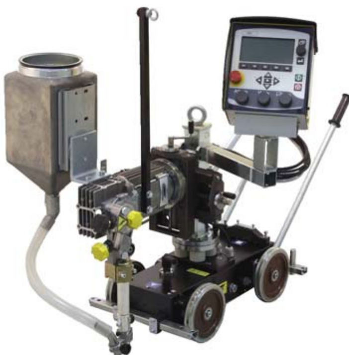
Kuva 6. Esab Oy:n A6 Mastertrac on nelipyörävetoinen hitsausautomaatti. Tämä hitsaustraktori soveltuu tehokkaaseen jauhekaarihitsaukseen. Hitsauslanka voi olla jopa 6 mm:n paksuista ja siinä voidaan käyttää 1500 A:n vaihto- tai tasavirtaa. /2/
