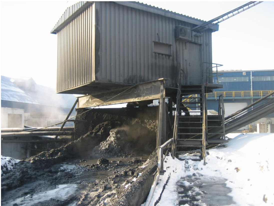
Kuva 11. Dekanterilingo pudottaa kiintoaineen kopin alle.
