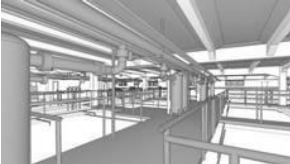
Kuva 17. Esimerkki Laserkeilatusta, ja tämän jälkeen 3D-pintamallinnetusta kuvasta Turun Seudun Vesi Oy:n vesilaitoksesta (2).
