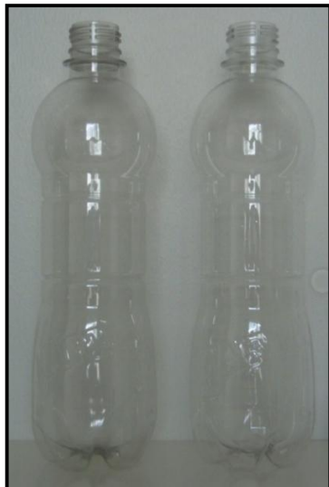
KUVIO 26. Vasemmalla oleva pullo on valmistettu R-PET:stä ja oikealla oleva pullo on valmistettu PET:stä
