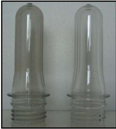
KUVIO 27. Vasemmalla oleva preformi on valmistettu R-PET:stä ja oikealla oleva preformi on valmistettu PET:stä
