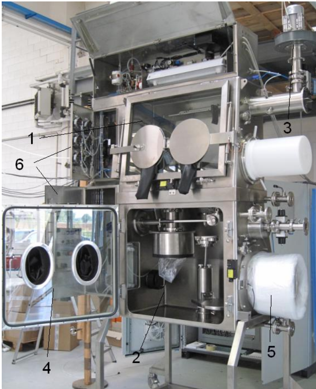
KUVA 2. Suodinkuivamen hanskakaappi ja osaluettelo.
