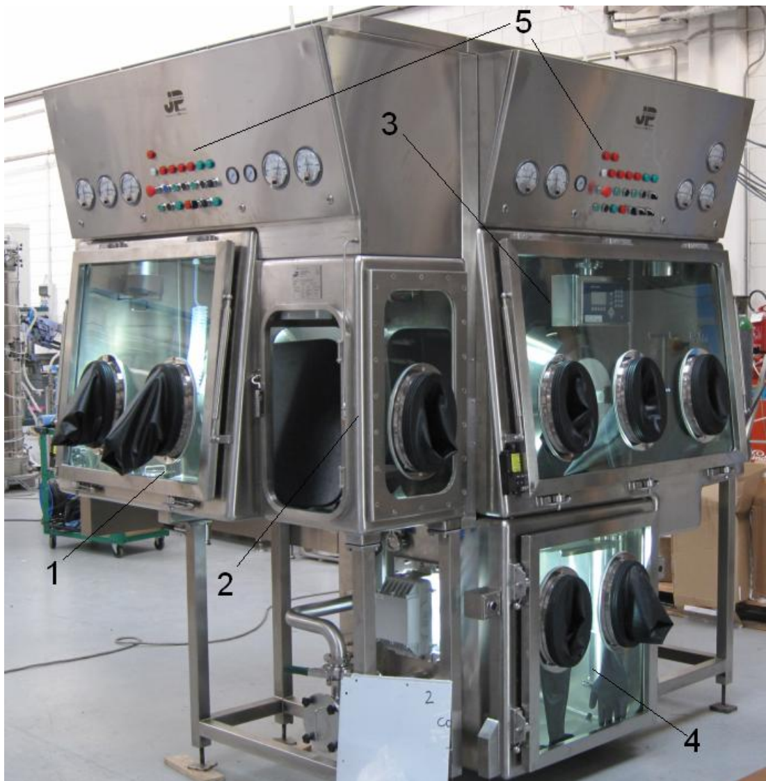
KUVA 3. Reaktorin hanskakaappi ja osaluettelo.
