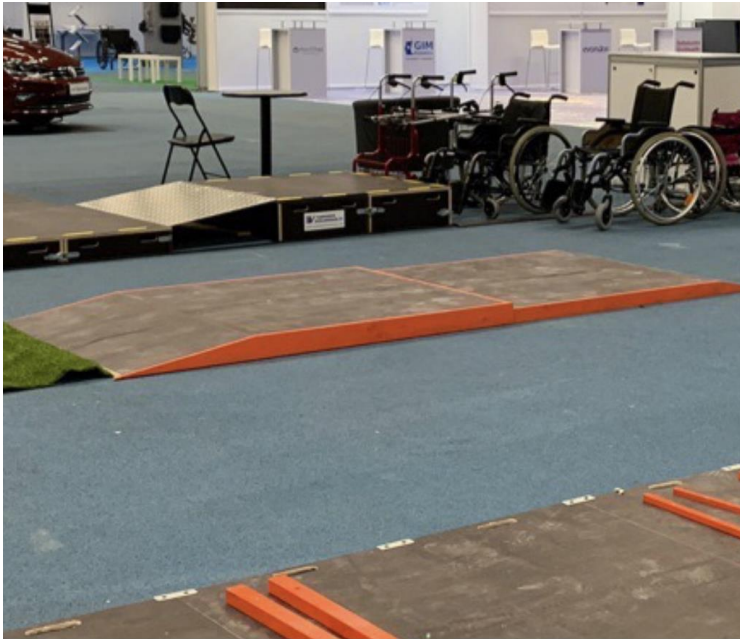
Kuvio 6. Peräkkäin sijoitetut 10 ja 7 senttimetriä korkeat tasoelementit luovat tasojen välille 3 sentin korkeuseron (Kuvio: Jaana Semenuka)
