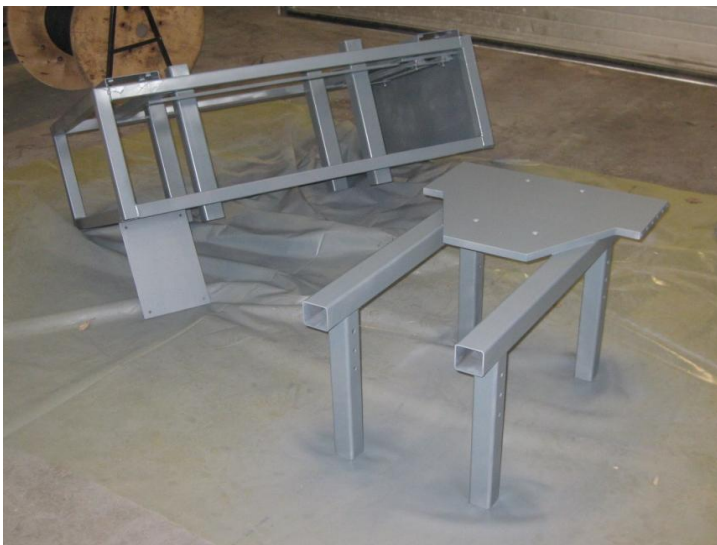
Kuva 11. Moottorin kiinnitystä varten tehty apurunko. Taustalla näkyy vaunun perusrunko ilman pyöriä.
