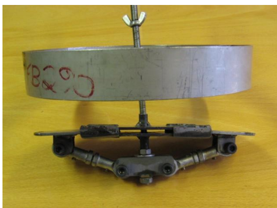
Kuva 4. Finbow Oy:llä käytössä oleva tarrain jota käytimme suunnittelun perustana.
