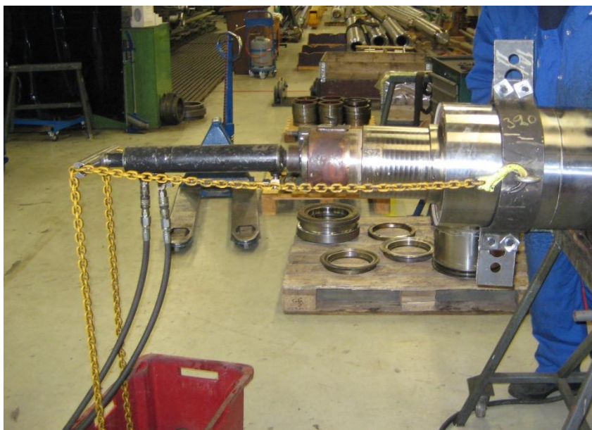
Kuva 1. Finbow Oy:llä aikaisemmin käytössä ollut työmenetelmä telojen purkamiseksi. Kuvassa näkyy myös vaippaholkin ulosvetoon tarkoitetut länget
