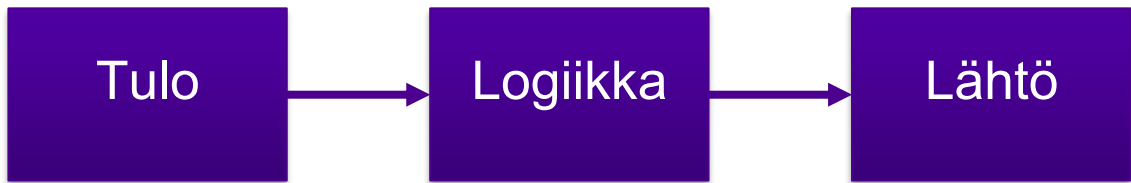
KUVIO 7. Tyypillinen kolmen alajärjestelmän rakenne. (Perustuu SFS-EN ISO 13849-1, 46)
