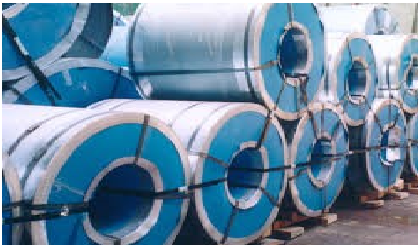
Kuva 14. Teräskelojen kiinnitys (Gard 2014, 6)
