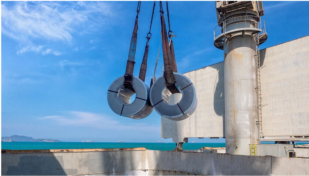
Yleisin Kuva 11. Teräskelojen lastaus nostovöillä (Dnvgl www-sivut 2019)
