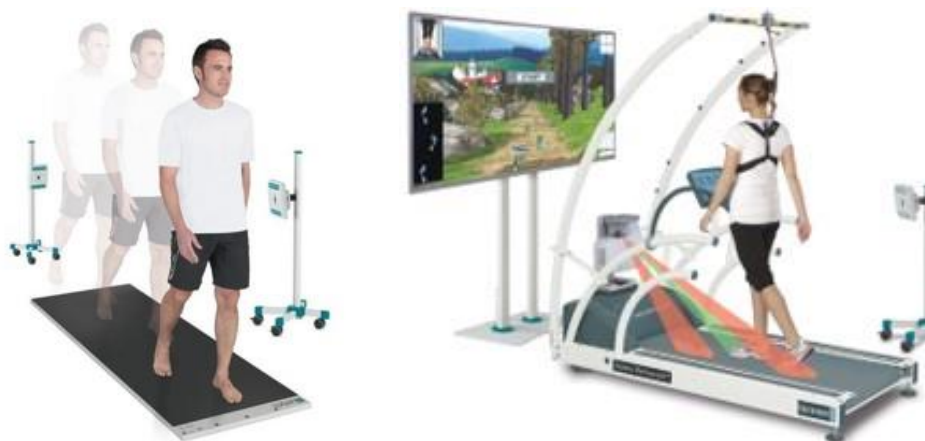
Kuva 4. Zebris-painesensorilevyt ja juoksumattoon integroitu Zebris-FDM-mittausjärjestelmä (Zebris 2018).
