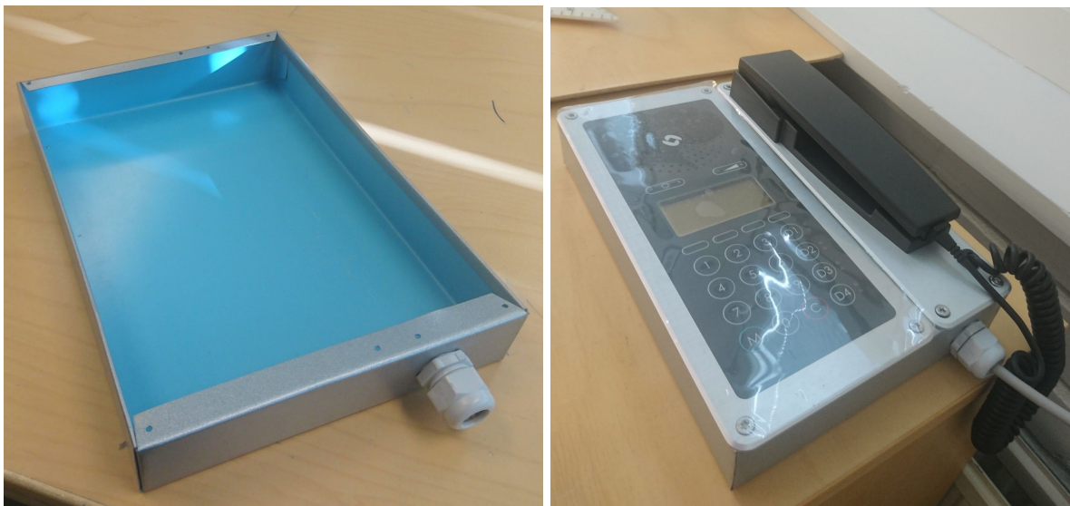
Figur 5. Egentillverkad skydds- och monteringslåda för IP-FLUSH station
