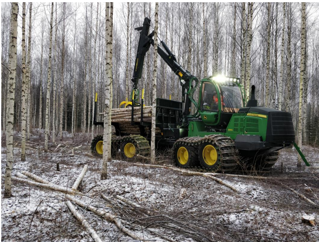
Kuva 2. Ajokoneella puiden kuljettaminen varastopaikalle käy huomattavasti kevyemmin kuin miestyönä. Kuvassa John Deere 1210G vm. 2018. (Kuva: Joonas Marjoniemi.)
