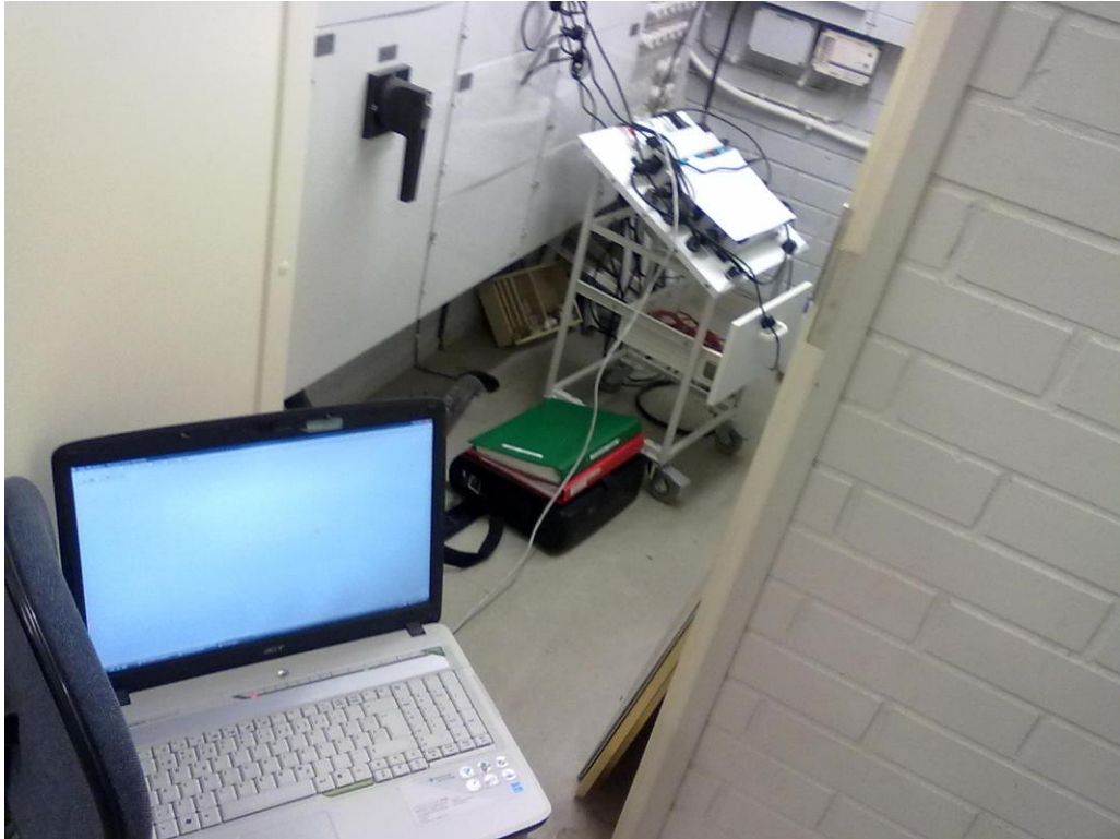
Kuva 1 Mittausjärjestelyt. Mittalaitteen asetukset määriteltiin paikan päällä kannettavan tietokoneen avulla, käyttämällä PQ-Analyze tietokoneohjelmaa.
