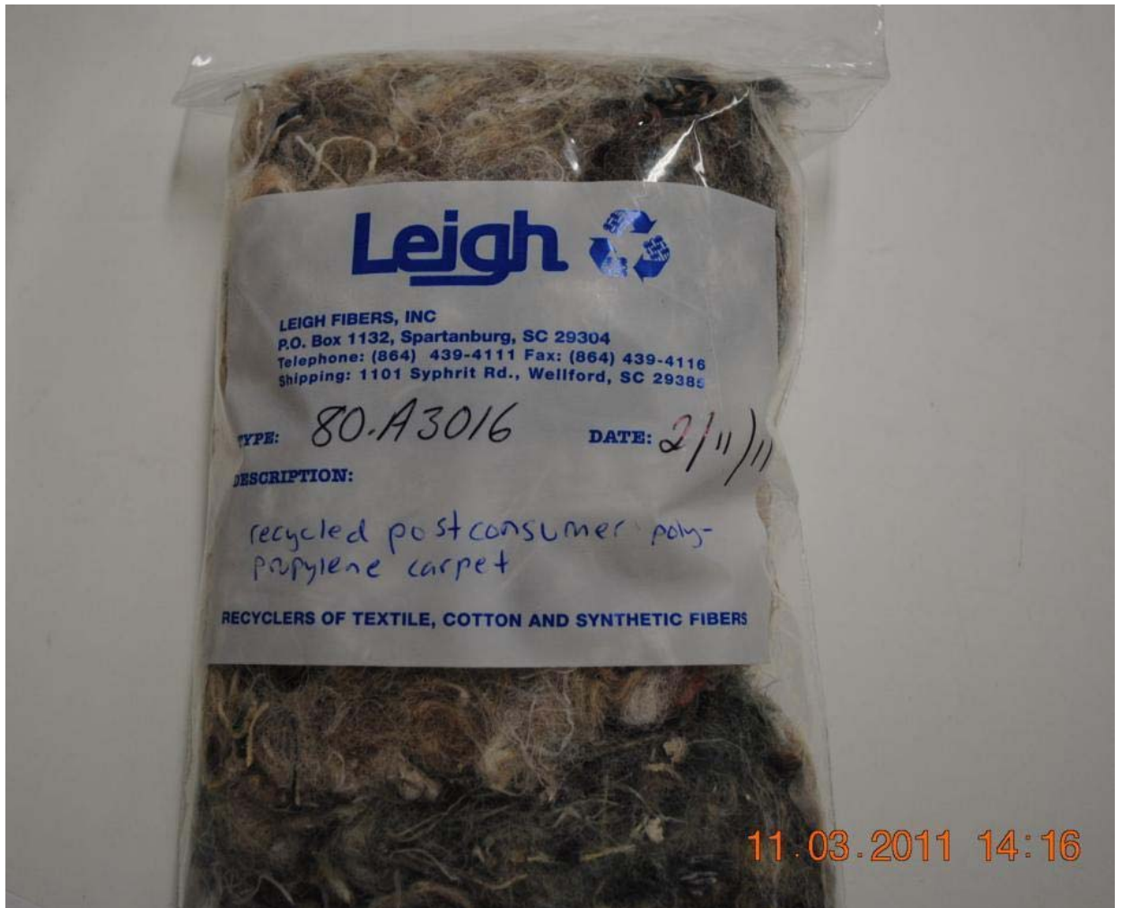
Kuva 1. Leigh fibers, Inc:n kierrätettyä polypropeeni mattokuitua kuluttajilta. (Kuva: Suominen Kuitukankaat Oy 2011, muokattu)
