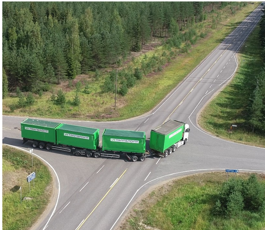
Kuva 19. Pituudeltaan n. 34 metriä pitkän HCT-yhdistelmän kääntyminen nelihaaraliittymässä (kuva: Mustaniemi, 2019).
