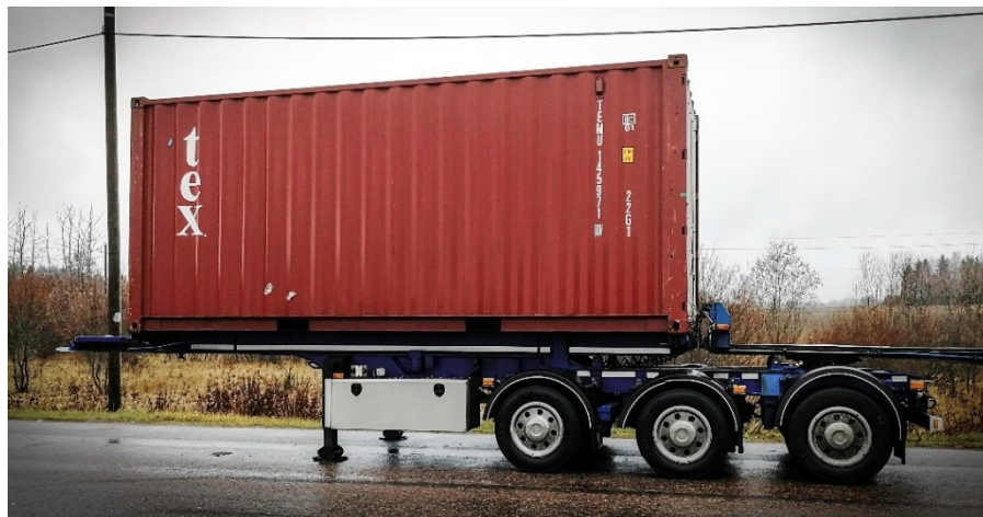
Kuva 7. Esimerkki linkkivaunusta (kuva: Nazarov, 2019).
