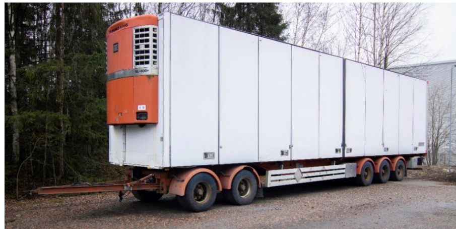
Kuva 4. Esimerkki varsinaisesta perävaunusta (kuva: Nazarov, 2019).
