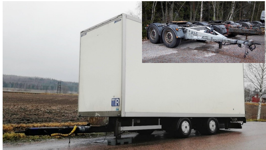
Kuva 5. Esimerkki keskiakseliperävaunusta ja apuvaunusta (dolly) (kuva: Nazarov, 2019).
