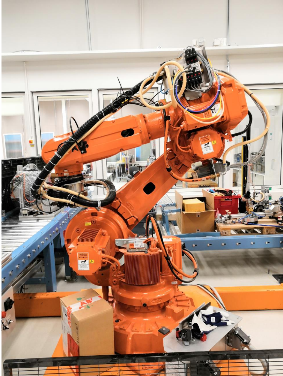
Kuvio 1. Lahden ammattikorkeakoulun ABB IRB 6620 Robotti (Niemi 2018)
