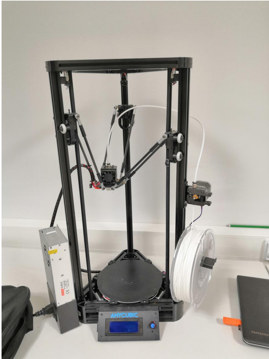
Kuvio 2. LAMK:n Anycubic Linear pulley 3D-tulostin (Niemi 2018)
