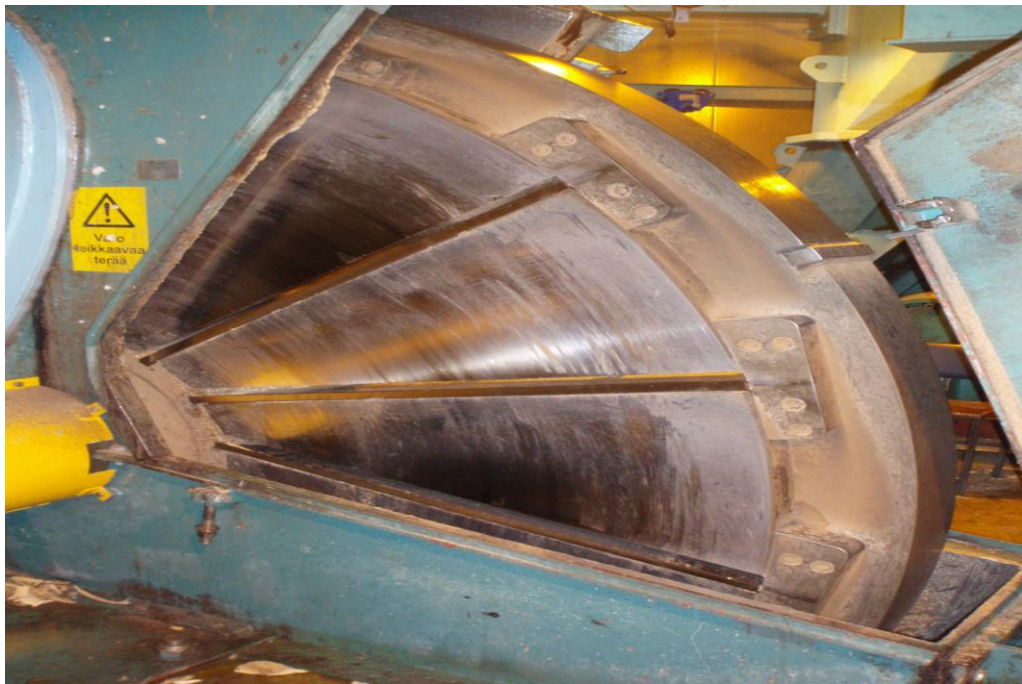
Kuva 6. Stora Enso kaukopään kuorimon 3-linjan pystysyöttöinen allepurkava kiekkohakku. Kuvassa näkyy hakun teräkiekko, terät ja terien yläpuolella sijaitsevat hakkeen poistoaukot.
