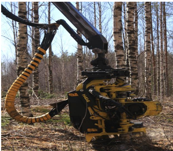
Kuva 11. John Deeren H414 harvesteripää. Harvesteripään yläpuolella näkyvät myös joukkokäsittelymenetelmän edellyttämät tartuntakäpälet
