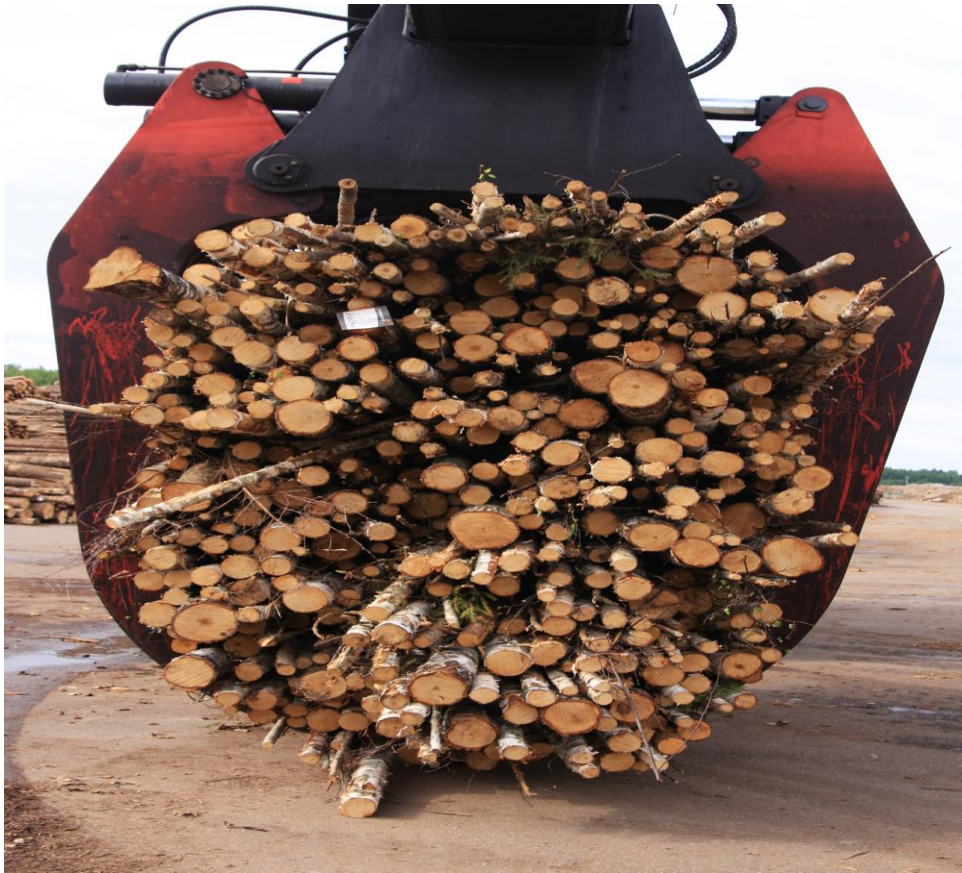
Kuva 15. JK-nippu puunsiirtokoneen pihdeissä
