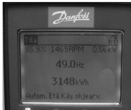
Kuva 22. Taajuusmuuttajan Danfoss VLT:n näyttötaulu
