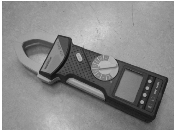
Kuva 16. Metrix MX 240 -sähkötehomittari
