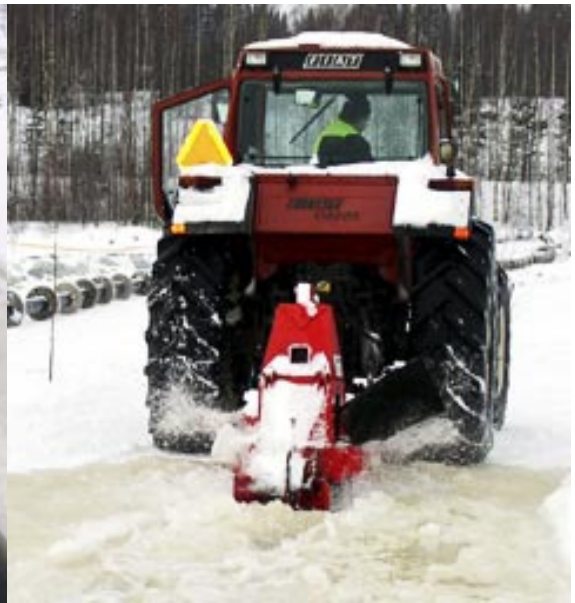
Kuva 10. Jääjyrsin toiminnassa (Jenergia, 2006).
