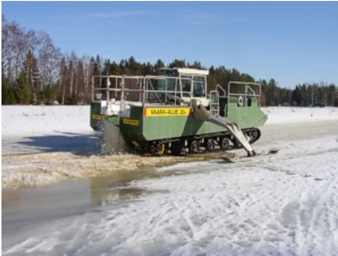
Kuva 11. Jäänsahauskone (Valtion ympäristöhallinnon verkkopalvelu. Kuva: Pauli Myllymäki, 2003).
