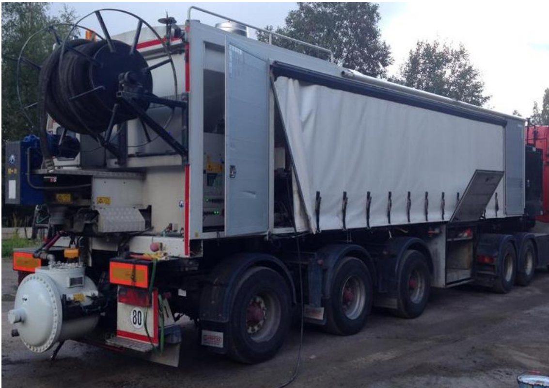
KUVA 9. Rekan perässä vedettävä maakostean betonin sekoitin-pumppu kalusto (24)
