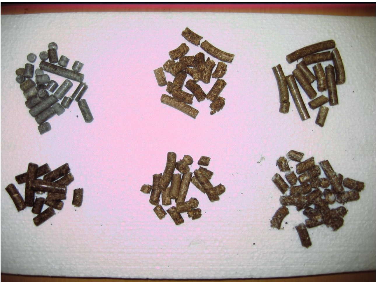
Kuva 13. Pellettejä eri materiaaleista. Vasemmalla ylhäällä sanomalehdestä, keskellä hakkeesta ja oikealla ylhäällä kauran oljesta puristetut pelletit. Vasemmalta alhaalla ruokohelvestä, keskellä hakkeen ja oljen sekoituksesta ja oikealla alhaalla rehupaalimuovin, oljen ja hakkeen sekoituksesta puristetut pelletit. Kuva Ritva Impola.
