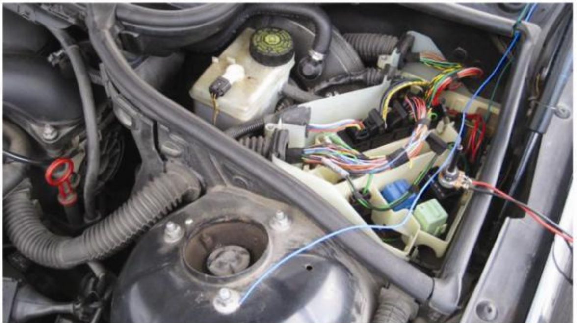
KUVIO 7. Säätövastuksen liittäminen moottorinohjausyksikön johtosarjaan.
