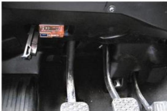
KUVIO 5. Diagnoosityökalu liitettynä testattavaan autoon.
