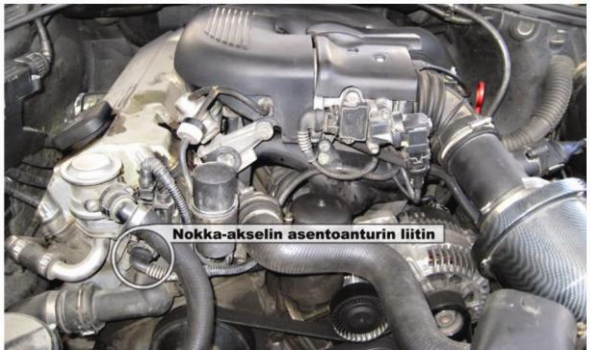
KUVIO 6. Nokka-akselin asentoanturin sijainti testattavassa autossa.
