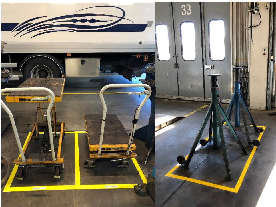
Kuva 5. Lattiamerkintöjä korjaamotiloissa muutoksen jälkeen
