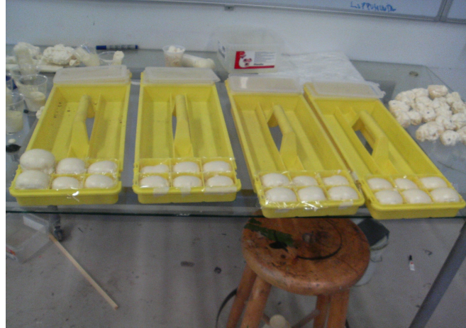
Kuva 12: Toinen uretaanisarja valettu.
