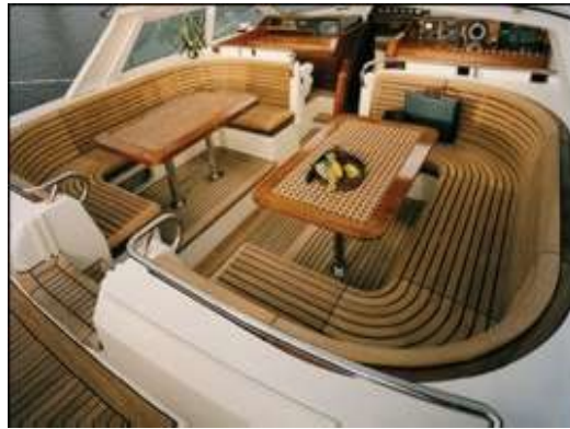
Kuva 8: Tiikkikannen saumat massattu (Oy Sika Finland Ab.)
