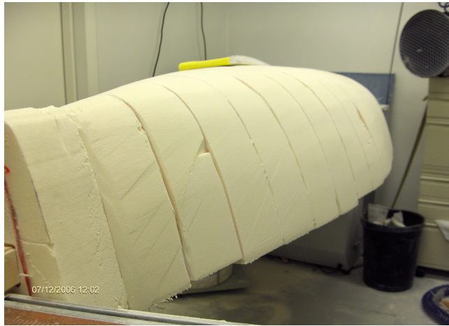
Kuva 10: Lestin valmistus polyuretaanivaahtolevystä
