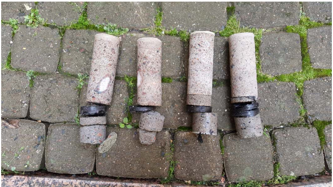
Kuva 29. Parvekelaatoista poratut koekappaleet.
