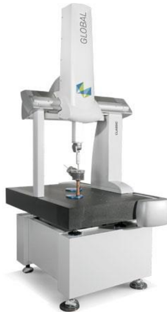
Kuva 1. Siltatyypinen koordinaattimittauskone (Hexagon 2019).
