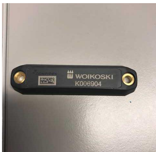
Kuva 7. Oy Woikoski Ab käyttämä RFID-tunniste
