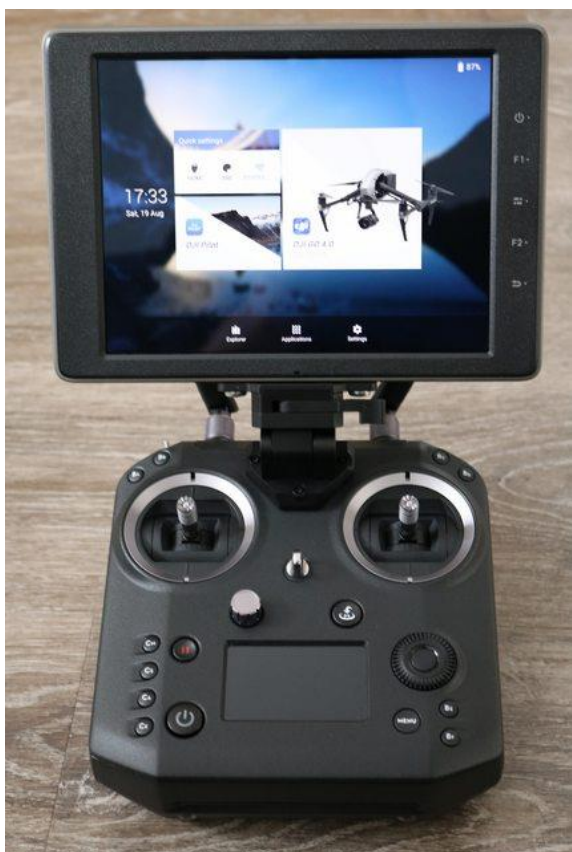
Kuva 15. Lisävarusteina saatavat DJI:n Crystalsky-näyttölaite sekä Cendence radio-ohjain (Inspirepilots 2017)
