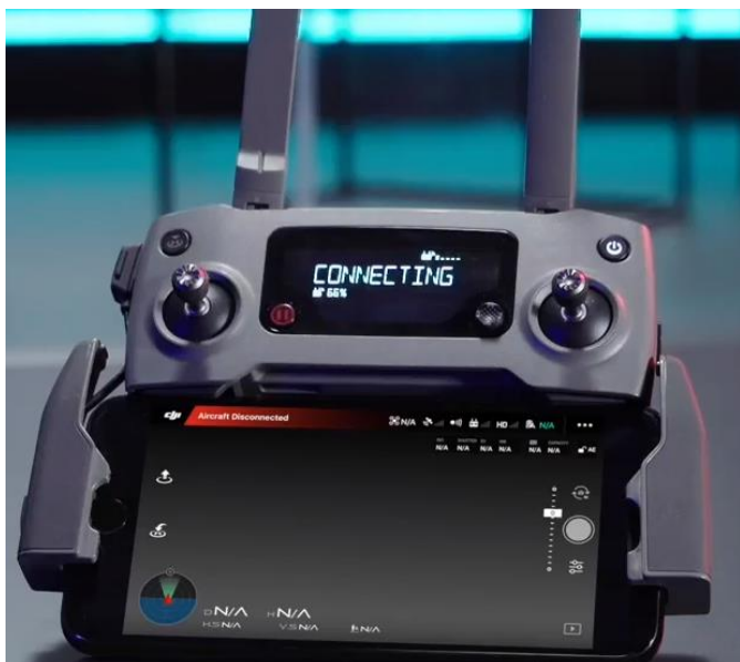
Kuva 16. Mavic 2 -dronen yksinkertainen ja pienikokoinen radio-ohjain, johon on yhdistetty puhelin (Heliguy 2019)
