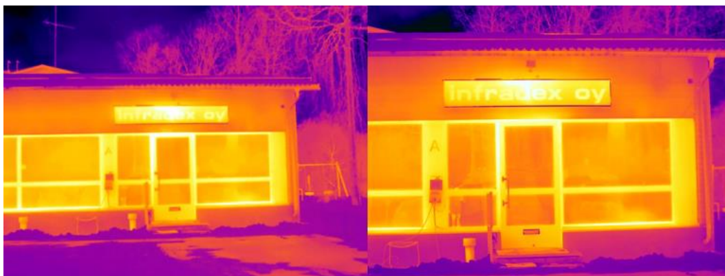
Kuva 24. Resoluutiot 480x380 ja 1024x768 (Infradex Oy 2016)
