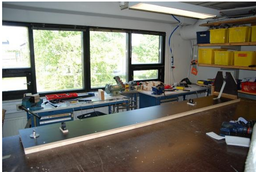
(figur 15, Färdig jigg för montering av y-stycket, foto: Jonas Renlund)
