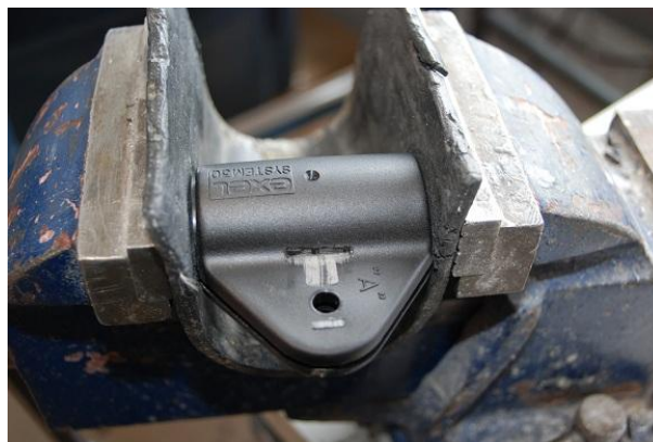
(figur 4, en färdigt skuren fläns, foto: Jonas Renlund)
