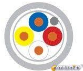
Kuva 4. KLMA 4x2x0,5+0,5 kaapelin poikkipintakuva
