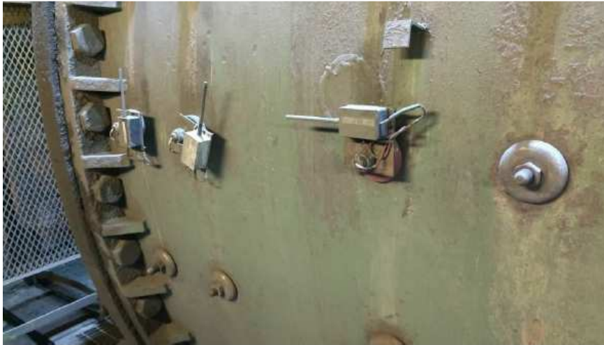
KUVA 35. Mittausanturin lähettimet myllyn ulkopuolella. (Kuva: Teknikum)
