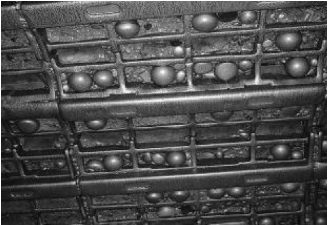
KUVA 15. Teräksiset verkkolinerit myllyn vaipalla. (Powell, Smit 2006. s. 3)
