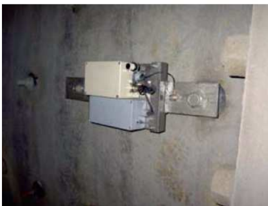
KUVA 37. Epäsuora mittauslaite myllyn kiinnityspulteissa. (Dandotiya, Lundberg. s.9)
