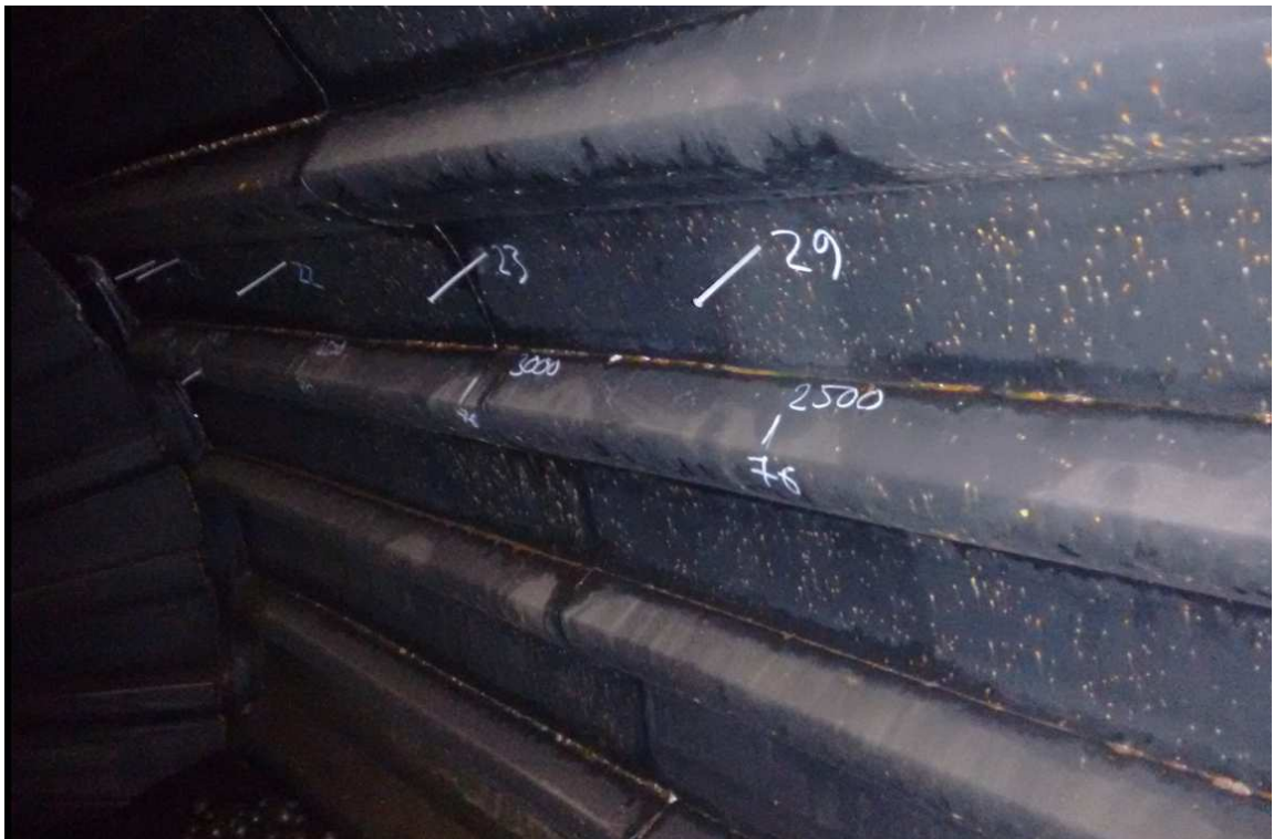
KUVA 22. Nostokorkeuden ja vaippalaatan mittaus manuaalisella menetelmällä. (Kuva: Teknikum)
