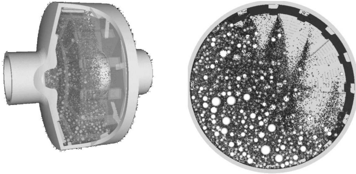
KUVA 8. AG myllyn periaatekuva. (Metallurgists & Mineral Processing Engineers)
