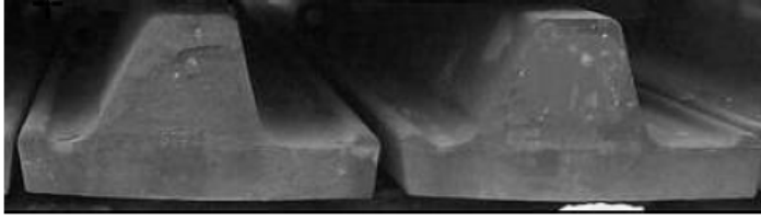
KUVA 21. yhteen suuntaan profiloidut epäsymmetriset nostajat teräsvuorausosilla toteutettuna. (Powell, Smit 2006)
