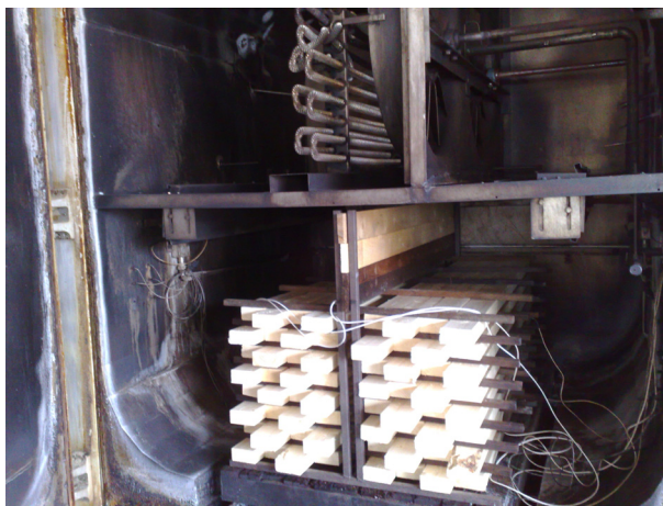
KUVA 10 Kuusisahatavara Salonsaaren Nardi -lämpökäsittelyuunissa
