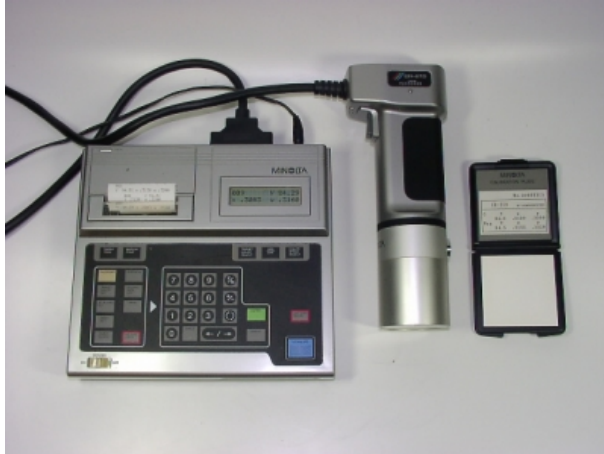
KUVA 14 Minolta Chroma meter CR-210 värianalyysilaitte
