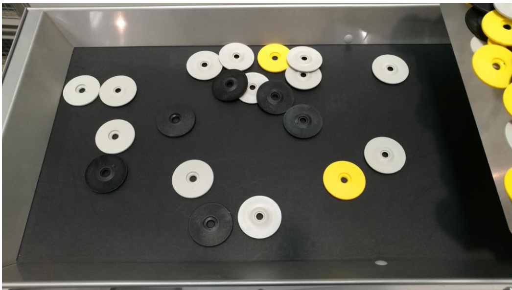
Kuva 26. Kappaleiden asema 10:n feed forward -komennon jälkeen.
