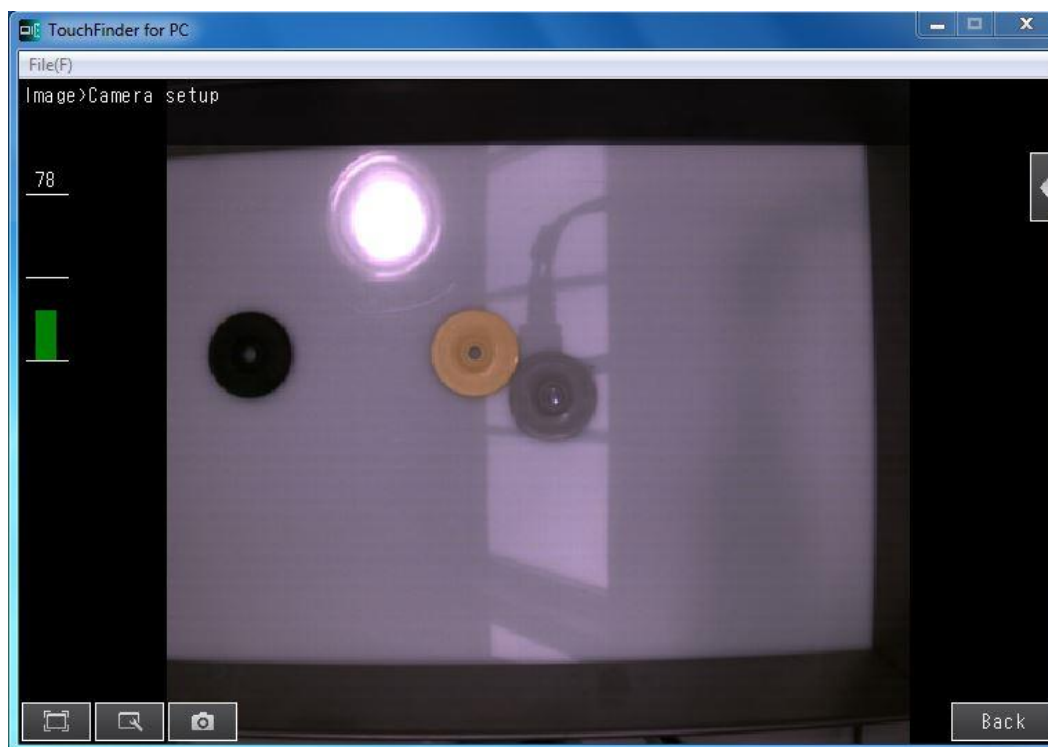
Kuva 21. Kuvaan heijastuneet laboratorion kattovalaisin sekä kattoikkunat.
