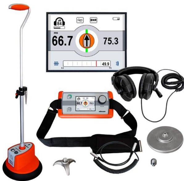
Kuva 6. Nykyaikainen maamikrofonilaitteisto. (Seba Digiphone Plus, complete)
