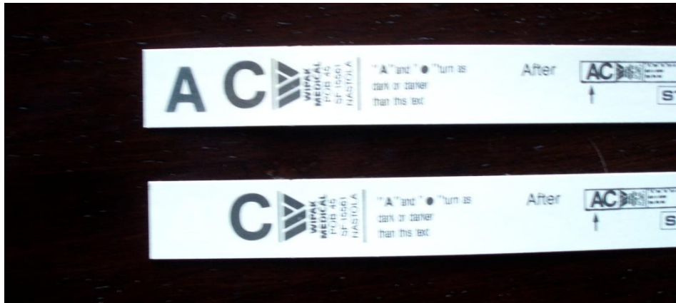
Kuva 24. Steriloidussa indikaattorissa (ylempi) kirjain A muuttuu tummaksi
