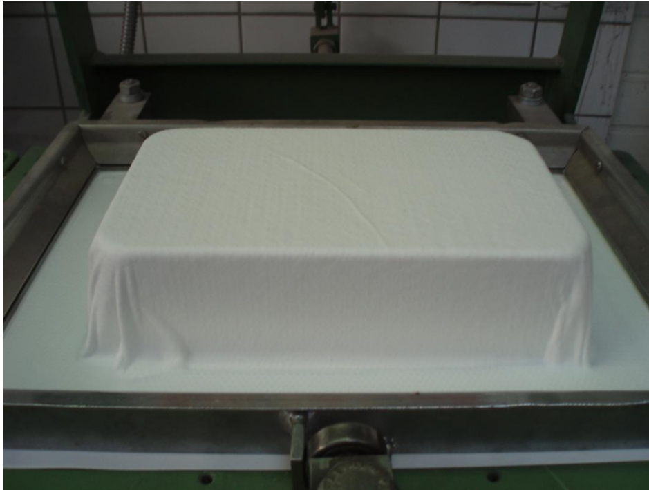
Kuva 11. Tyhjiömuovauksessa muovilevy imetään muotin päälle
