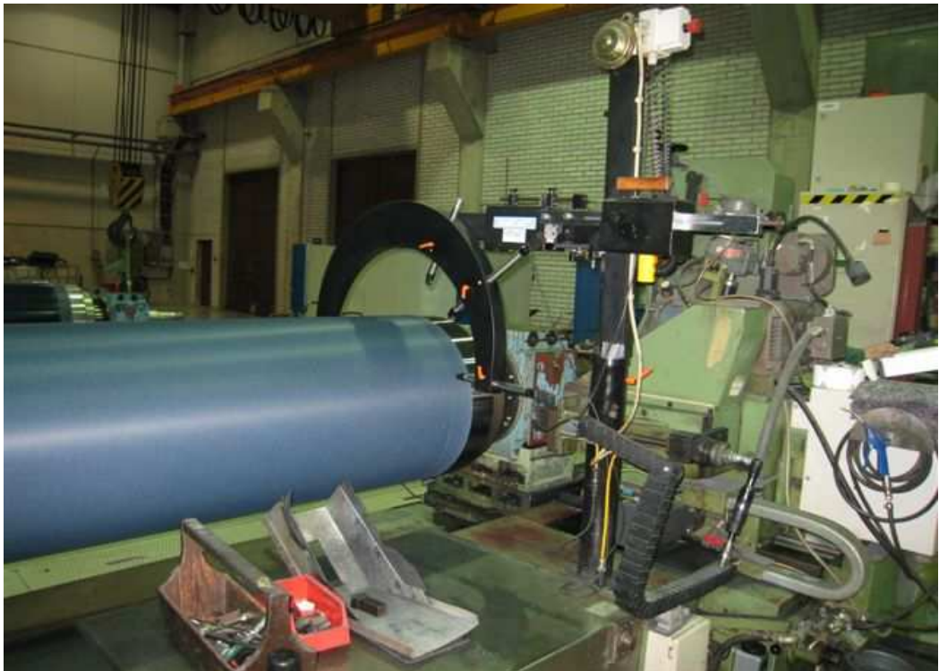
KUVA 3. Safop-nauhahiomakone, kuitutela ja mittalaite.
