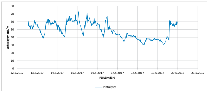
Kuva 4. YSI-sondin likaantuminen vaikutti johtokyvyn mittaustuloksiin mittauksen alkuvaiheessa.
