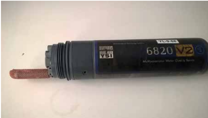
Kuva 3. YSI-sondin johtokykyanturiin laitettiin kupariverkko (kuva Riina Tuominen).
