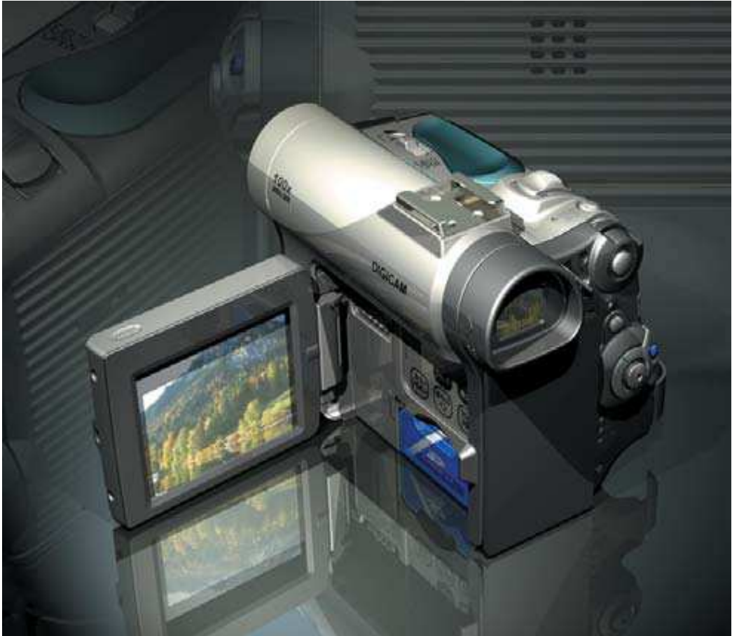
Kuva 6. Visualisointityökaluilla voidaan valmistaa valokuvarealistia kuvia mallinnetuista kappaleista. (Siemens PLM Software. NX Visualize and NX Render: 1)
