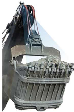
Kuva 6. Kauhan kynnen puuttumisen tunnistava kamerajärjestelmä. (Motion Metrics, 2016).
