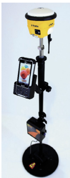
Kuva 10. BMT:n kehittämä laite, jonka avulla anturit voidaan paikantaa kasan päälle menemättä. (BMT, 2016)
