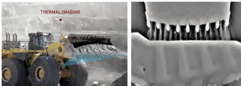
Kuva 7. Kynnen puuttuminen tunnistetaan lämpökameran avulla. Oikealla lämpökamerakuva (Motion Metrics, 2016)
