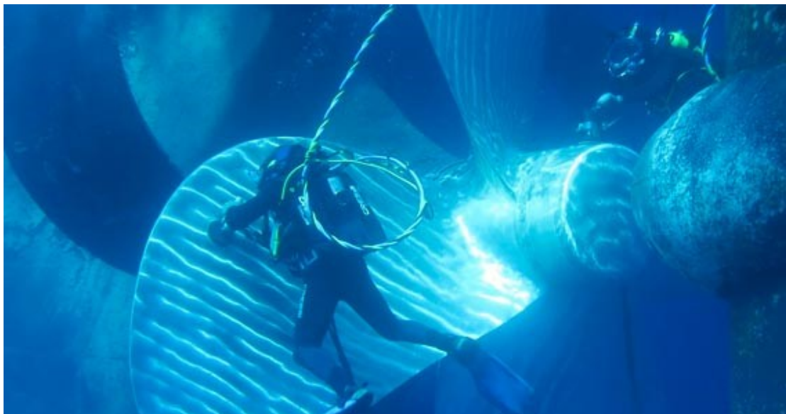
Kuva 10. Potkurin puhdistus ja kiillotus (Commercial diving services 2013).
