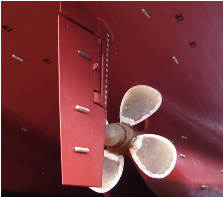
Kuva 13. Aluksen pohjan sinkkilevyt (Reid. Sacrificial anodes. 2013).
