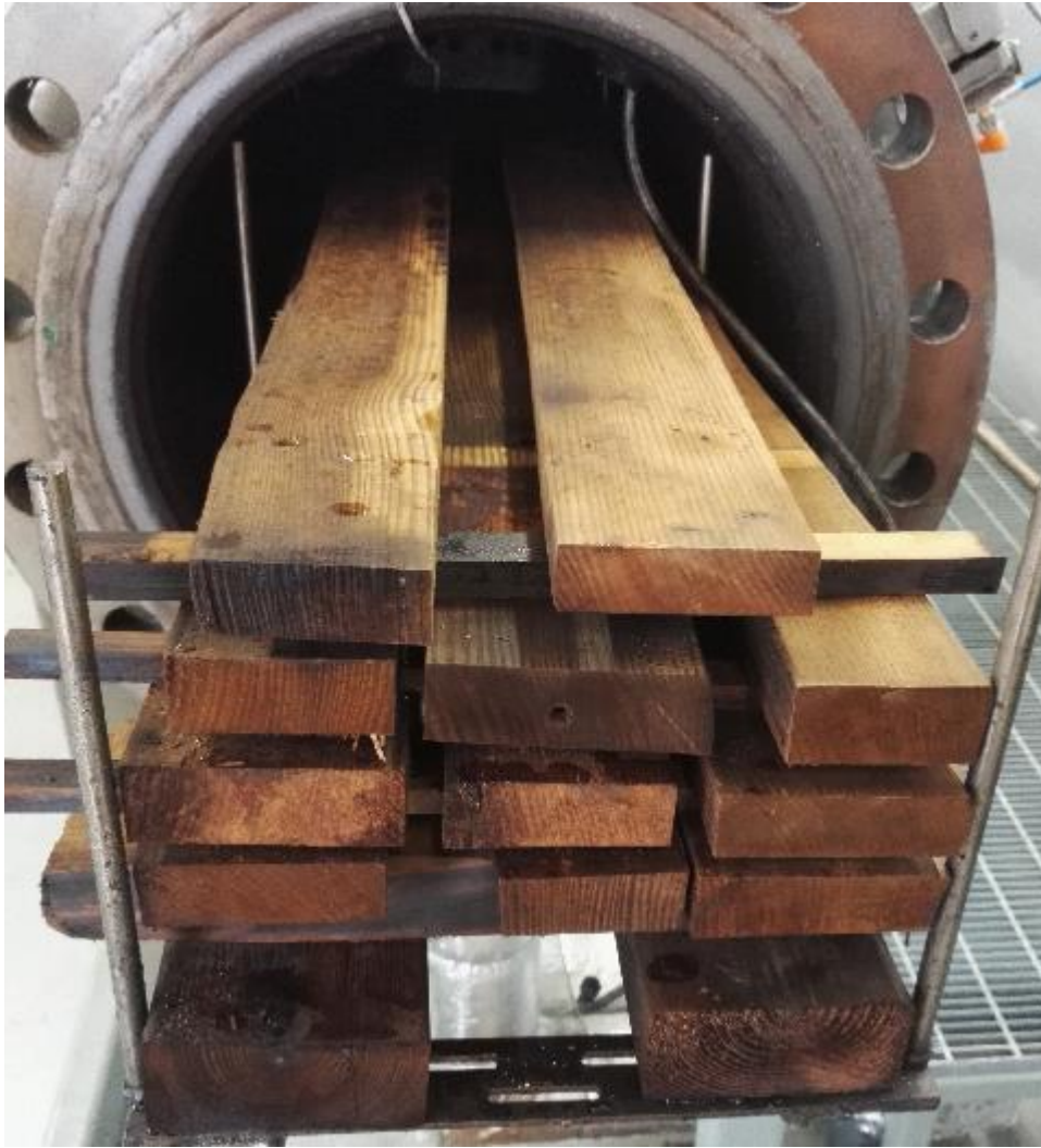
Kuva 8. Tuore sahatavara höyrylämpökäsittelyn jälkeen
