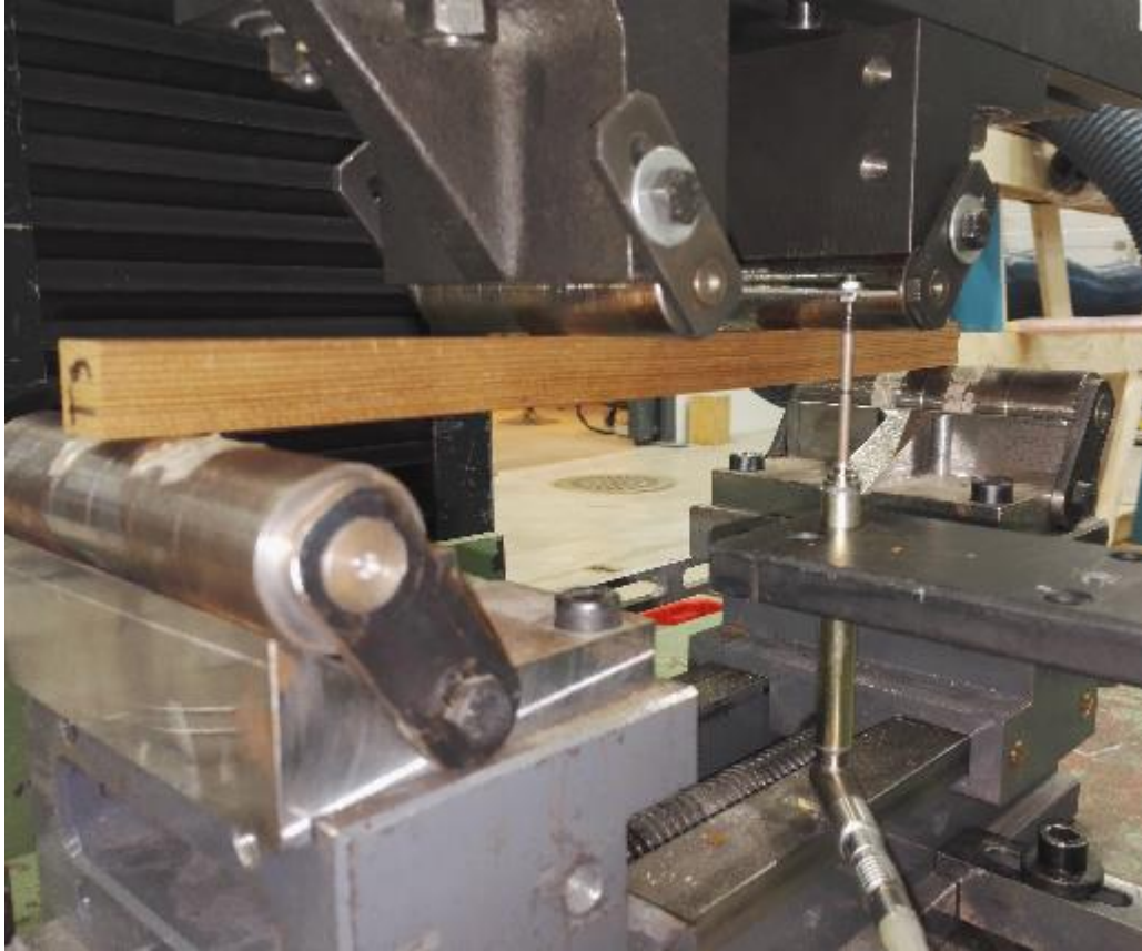
Kuva 11. Koekappaleen 4-pistetaivutus kuormituskehällä
