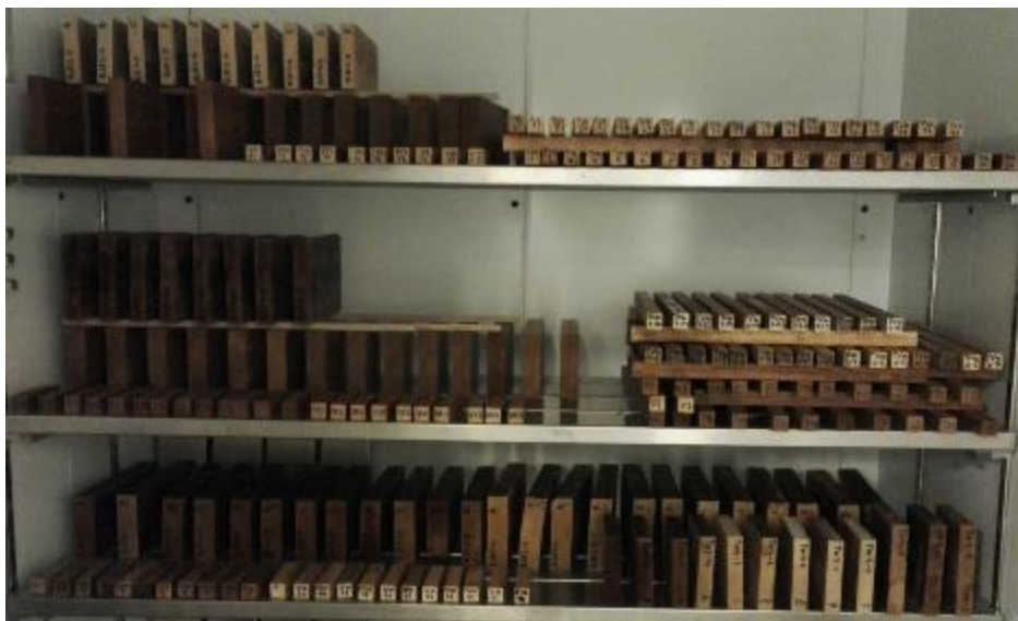
Kuva 5. Koekappaleet tasaantumassa olosuhdekaapissa, RH 65 % ja T20 °C
