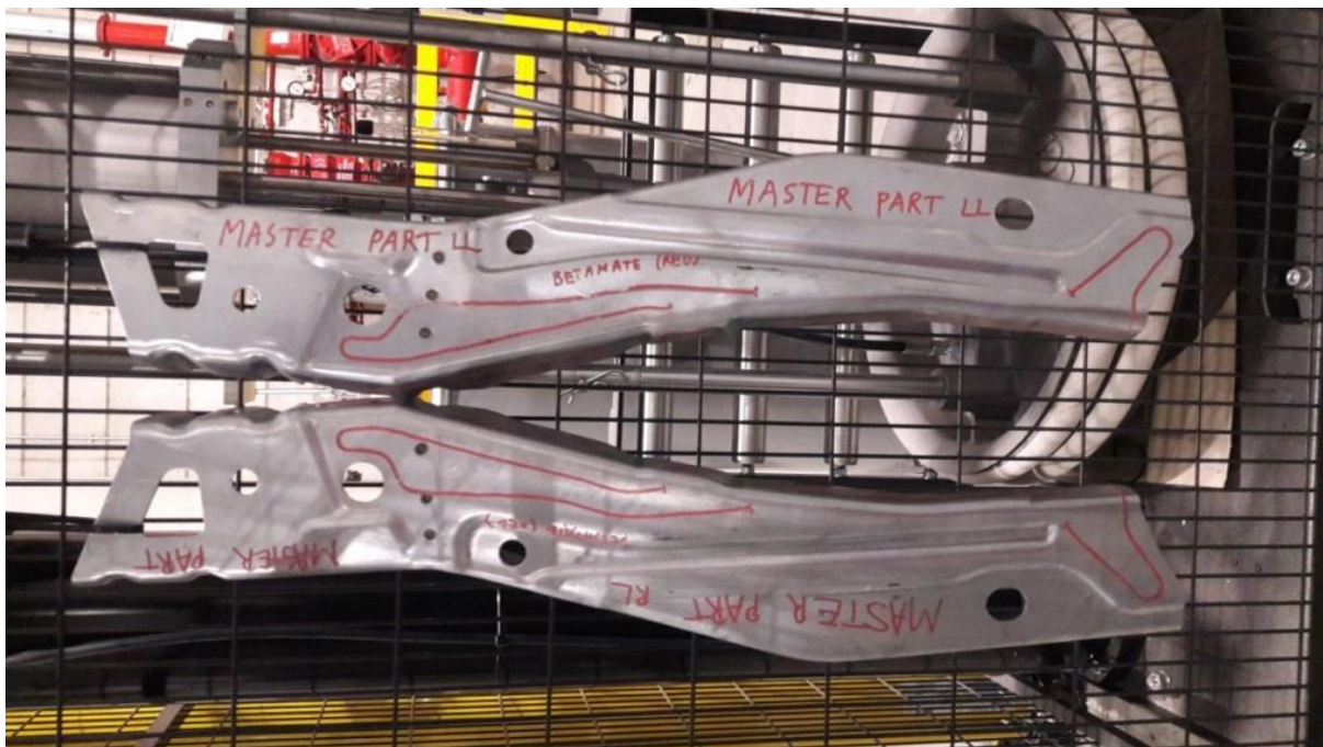
Kuva 39. Master part -osat, joihin on merkitty liimauksen sijainnit.
