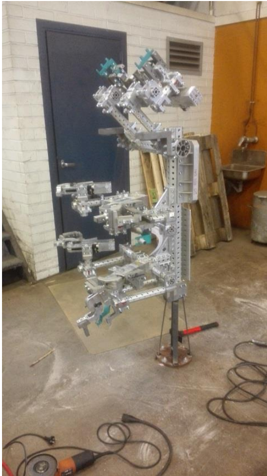
Kuva 30. Tarttujan varustelu on helpompaa telineessä.
