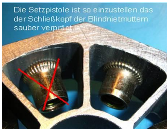
Kuva 32. Niittimutterien asennusohje ja käytettävä työkalu.
