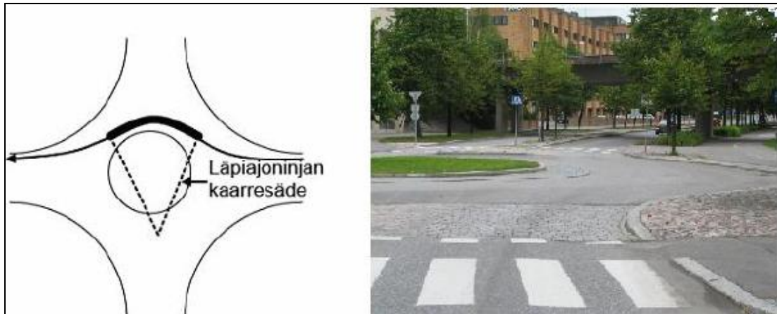
KUVA 26. Kiertoliittymän läpiajoninjan kaarresäde (Kiertoliittymien turvallisuus, 2008, 19)
