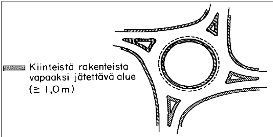
KUVA 16. Kiertoliittymän kiinteistä rakenteista vapaaksi jätettävät alueet (Tasoliittymät, 2001, 79)
