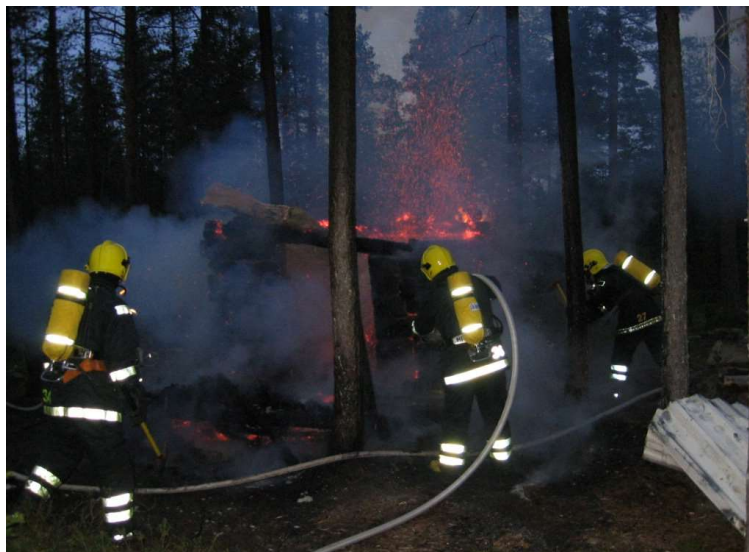
Kuva 3. Metsäpirtin hirsisauna täyden palon jälkeisessä sammumisvaiheessa ja palaminen tapahtuu enää enimmäkseen hehkupalona.
