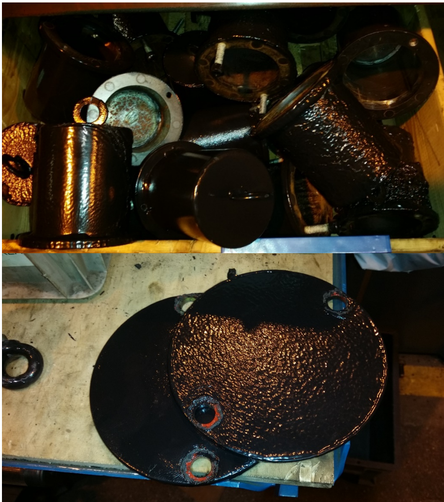
Kuva 2. Teräksisiä suojakappaleita, joissa kertyneenä useampia maalikerroksia.
