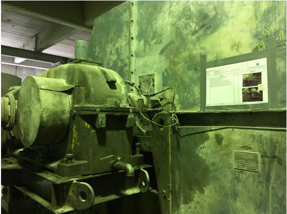
Kuva 5. Esimerkki työohjeen viennistä neljännen kerroksen ylätasoon elevaattorin moottorin viereen
